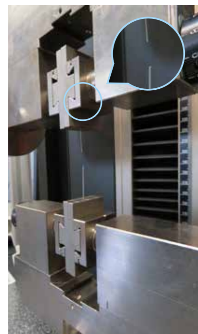
Figure 1. Équipement d'essai de résistance et d'allongement des fibres Zwicky 5kN (Zwick Roell, Allemagne).
