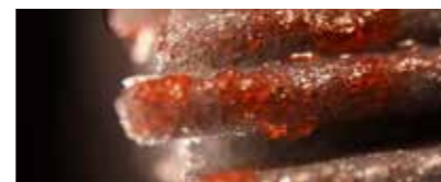
Figure 6b. Fibres en métal détectable après nettoyage (grossies 160x).
